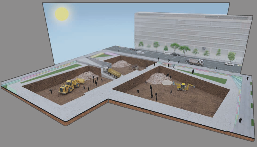
ETAPA DE FUNDAÇÃO TIPO DE SOLO: ÁREA COM INFLUÊNCIAS ANTRÓPICAS ESTACA ESCAVADA – HÉLICE CONTÍNUA
