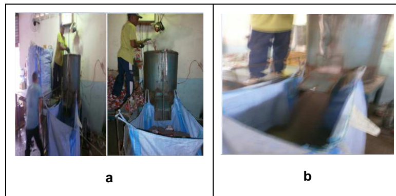
Figura 2 - Processo de aglutinação dos resíduos plásticos
